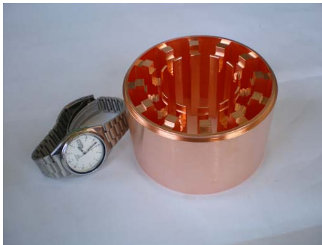
Рис. 4. Резонатор мощного импульсного магнетрона, изготовленный электроискровым способом
