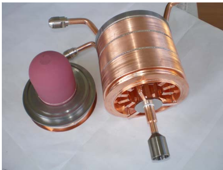
Рис. 3. Анодный блок и вывод энергии мощного импульсного магнетрона
