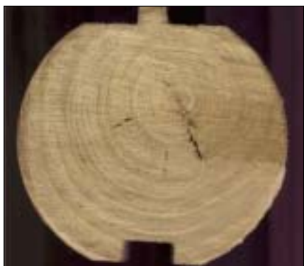
Рис. 4. Оцилиндрованное бревно лиственницы, высушенное СВЧ-способом до 10% влажности.
